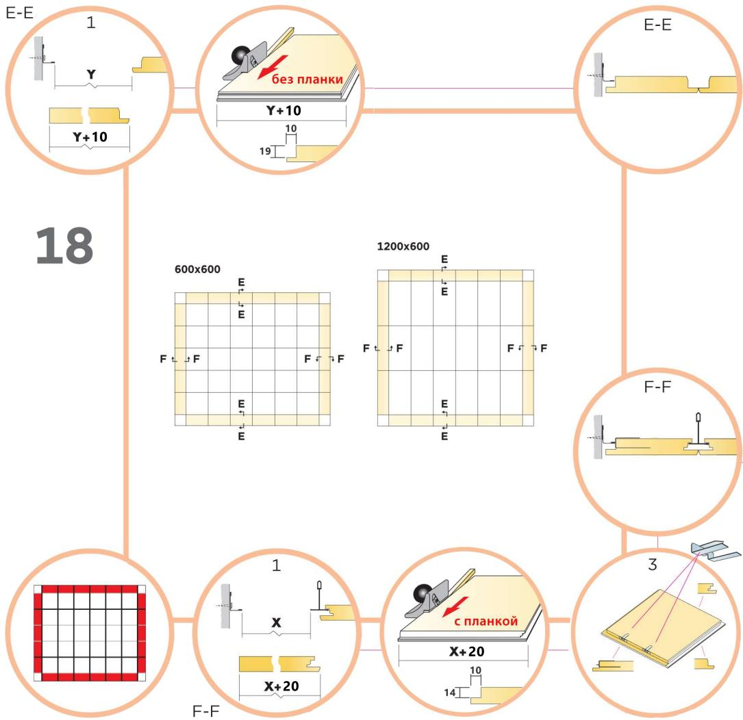
После обработки кромки торец панели рекомендуется прокрасить
